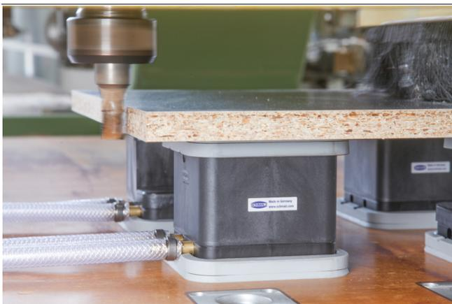
Blocs de bridage VCBL-G-K2 pour le bridage d'un panneau d'aggloméré
